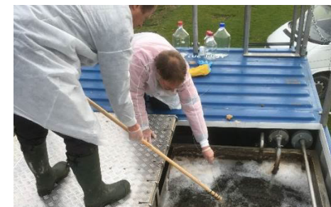
Prøvetagning i membran-testanlægget.
